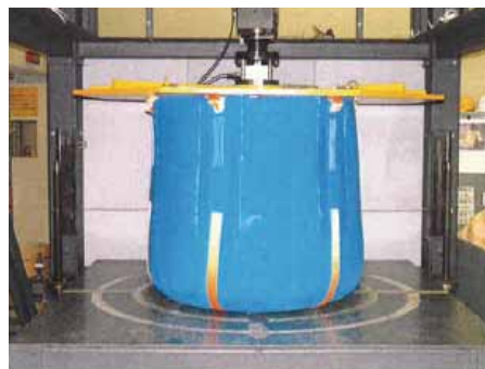
圧縮試験及び積重ね試験状況
